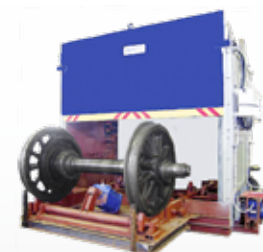
Оборудование для мойки колес и деталей вагонов
